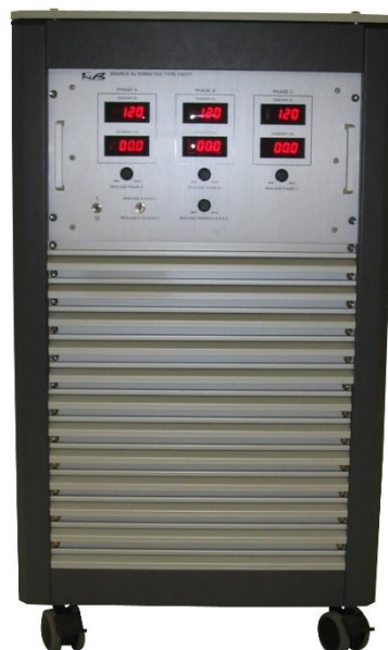
Source AC/AC Triphasée : Entrée 230Vac (47 à 440Hz) Sortie Triphasée 115Vac 400Hz 12KVA Application Industrie Option : Afficheur (tensions, courant) sur les 3 phases
