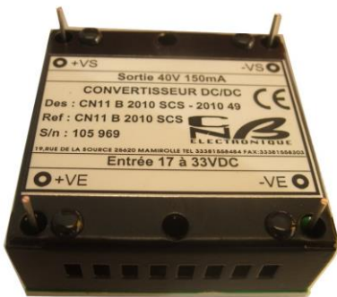
Convertisseur DC/DC : Entrée AIR2021E (12 à 60 VDC) Sortie 40 Vdc 160mA 6.5W Application Militaire embarquée Température d'utilisation -40°C à +85°C Dim : 52 x 52 x 20mm
